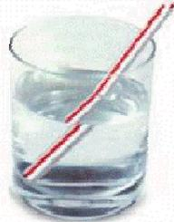
La rifrazione è il fenomeno per cui un'onda subisce una deviazione quando questa passa da un mezzo fisico ad un altro, cambiando la velocità di propagazione.
