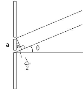
L'interferenza è il fenomeno per cui la sovrapposizione due fasci luminosi in un dato punto, porta ad un comportamento distruttivo o additivo delle stesse onde
